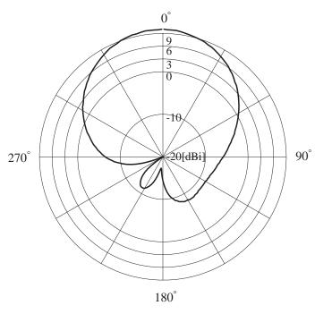
測定周波数: 2.5 GHz アンテナ利得: 9.6 dBi 電力半値角: 66 度
