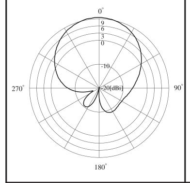
測定周波数: 2.45 GHz アンテナ利得:10.0 dBi 電力半値角:70 度
